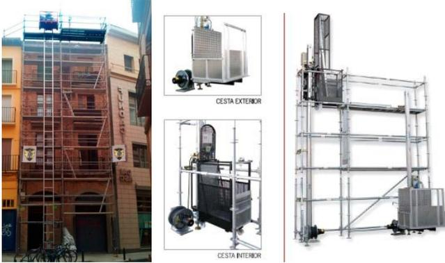
En obras de rehabilitación o reforma, con accesos difíciles en interior, con objeto de reducir las operaciones de transporte manual de cargas, y **minorar los daños en espalda, lumbares y en general el esfuerzo físico del trabajador**, pueden utilizarse **montacargas eléctricos de pequeña dimensión**, que ocupan poco espacio y su diseño, permite tanto el montaje con cesta exterior, como la instalación con cesta interior.
