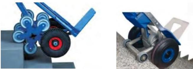
Para el **transporte de cargas** (materiales, herramientas, etc.) por el interior de edificios que presentan difícil accesibilidad, es posible utilizar **carros dotados de un sistema de ruedas múltiples**,
