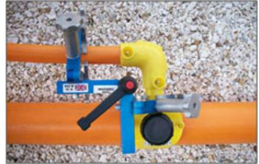
Figura 6. Soldadura por electrofusión. Fuente: <http://www.blogplastics.com>
