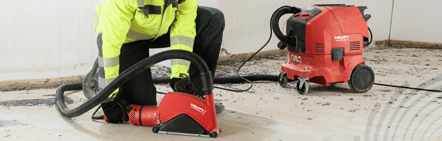
**La amoladora o radial es una máquina eléctrica portátil que sirve para cortar, desbastar y pulir y que funciona con un motor de pequeño tamaño que hace girar un disco a altas revoluciones.**
