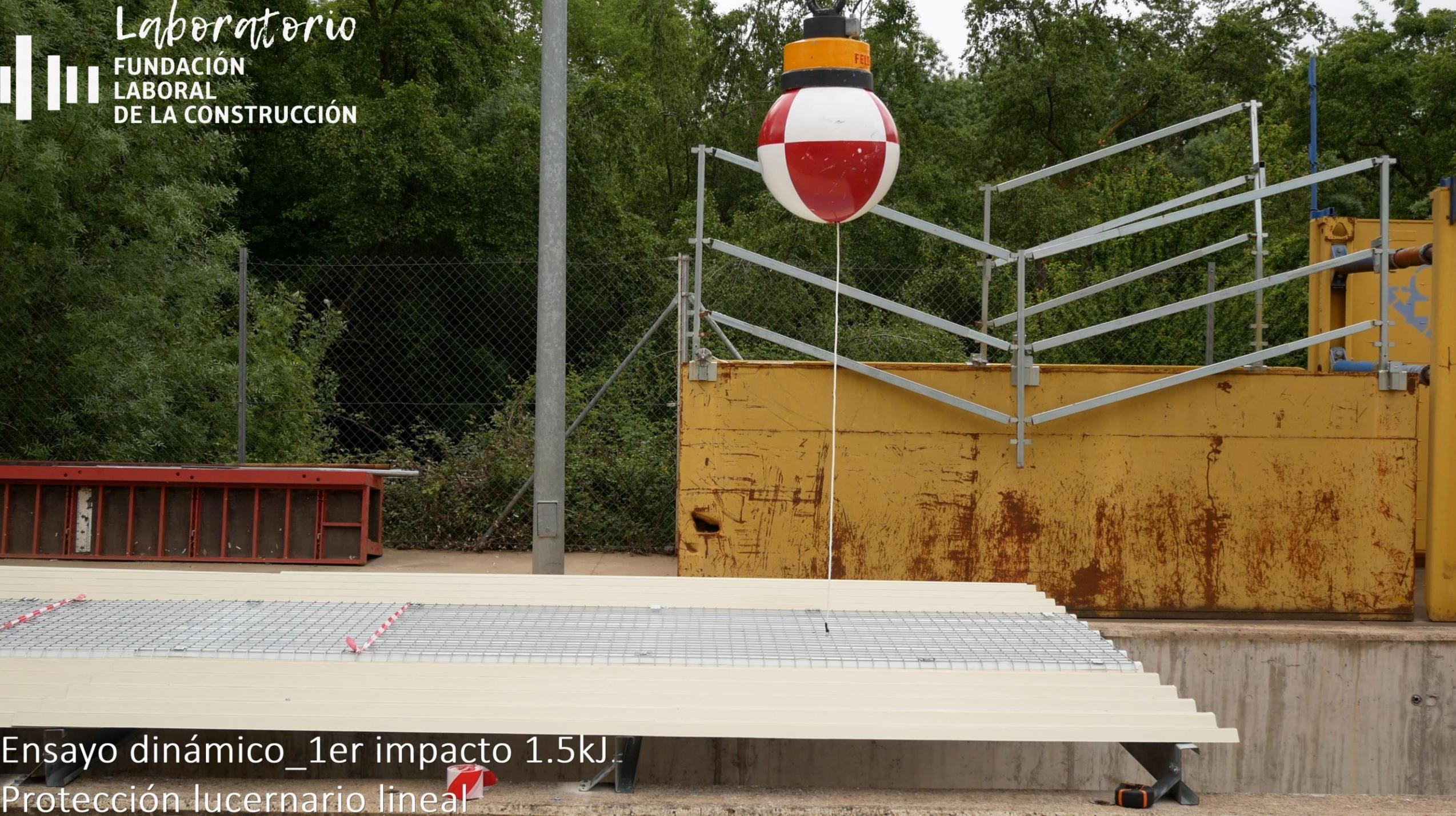
Ensayo dinámico\_1er impacto 1.5kJ.
