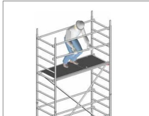
5. Subir al siguiente nivel e instalar las barandillas 13 a la altura de 0,5 metros (segundo peldaño encima de la plataforma).
