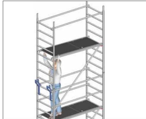
4. Insertar las diagonales 16 y la plataforma de acceso 24. Las diagonales tienen que instalarse como en una torre (en zig-zag) en ambos lados.
