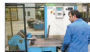
Fig. 1.10: Máquina para comprobar la carga de las horizontales y las bases
