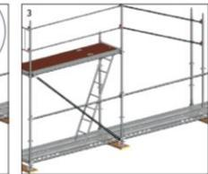
3. Subir el conjunto e insertar el vertical AGS en la espiga. Montar el horizontal en "U", colocar la plataforma y montar el horizontal en el exterior al nivel de la plataforma. Desmontaje en orden inverso.
