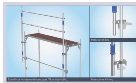
La actual normativa de seguridad exige que se debe proporcionar, en un andamio para el trasiego horizontal en el nivel superior de montaje, una barandilla de protección. Como requisito adicional se debe proporcionar una barandilla doble (barandilla y barandilla intermedia) en la zona de trasiego vertical de los materiales. En vista de estos requisitos Layher ha mejorado las prestaciones del poste de montaje.
