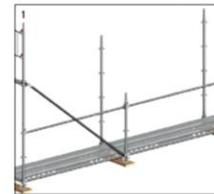
1. Comenzar por la parte exterior del andamio con verticales de 1,00 m. Montar el primer vertical AGS con barandilla lateral AGS previamente montada. Montar una horizontal en "U" y una diagonal Allround.
